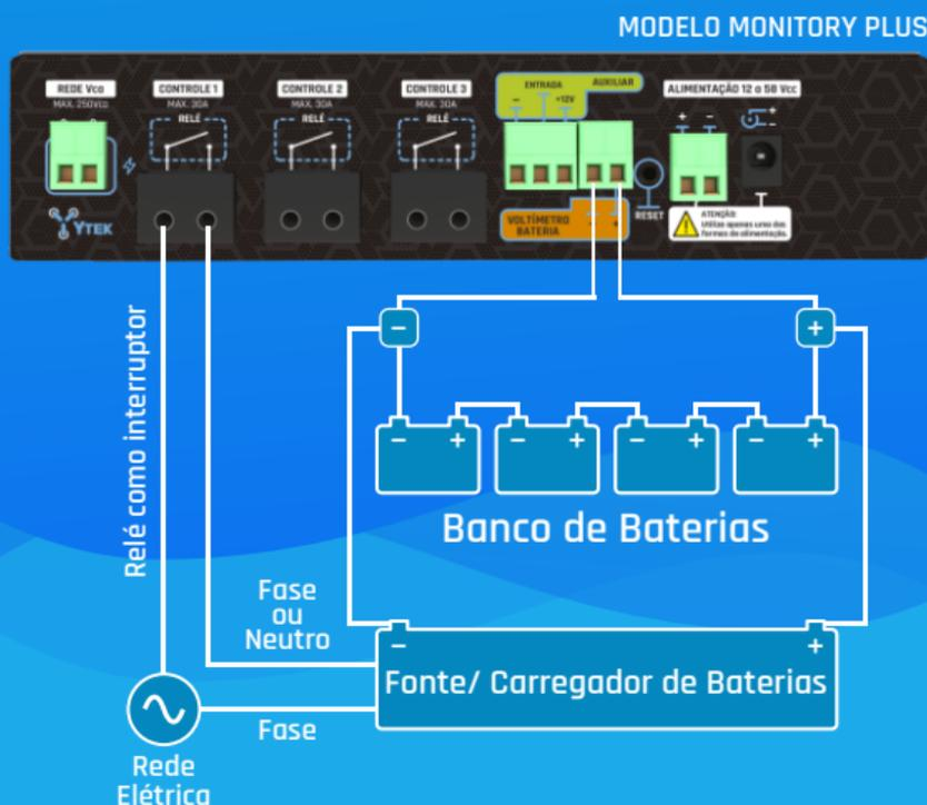
\* O teste é feito por tensão, então não há limite na corrente do banco de baterias. Para fontes com consumo acima de 30A é necessário utilizar contator acionado pelo relé do MONITORY.
