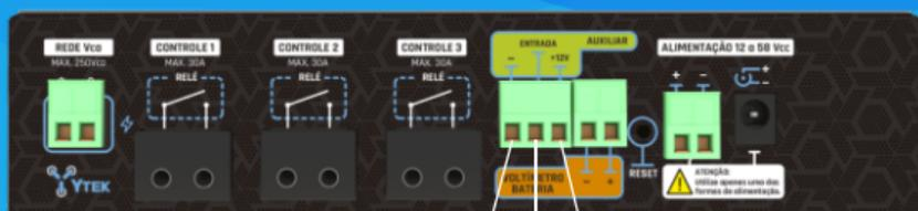
Alimentação para o sensor de fumaça com saída 12v 1A máxima
